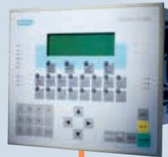
Controle e programação das máquinas através de ferramentas standard como STEP7<sup>2</sup>, TwinCAT<sup>3</sup> ou LogixStudio<sup>4</sup>
