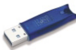
Figura 1.2: Exemplo de chave USB HASP
