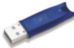
Abbildung 1.2: Beispiel für einen HASP-USB-Schlüssel
