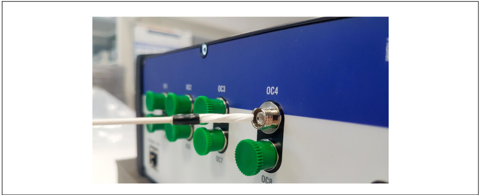
図3.28 インテロゲータのコネクタアダプタのクリーニング
