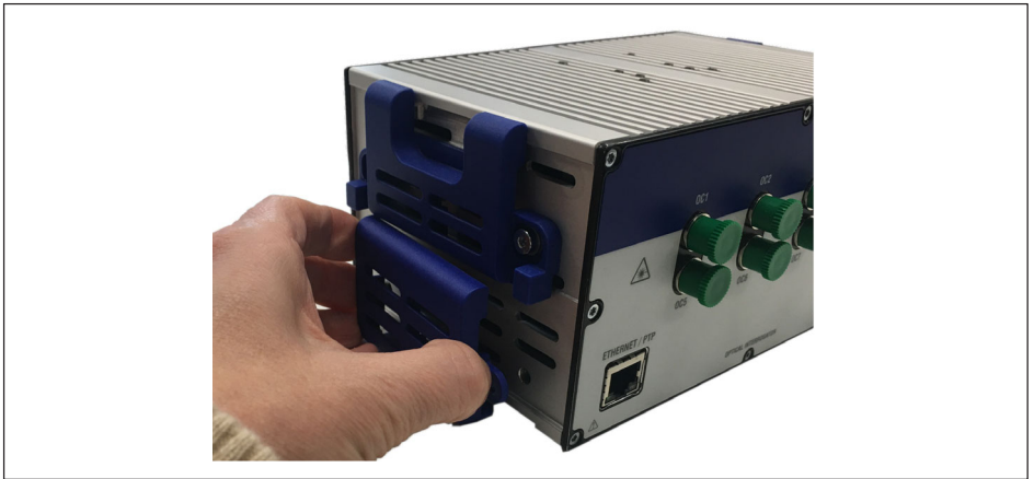
図3.14 底部サイドカバーの取り外し
