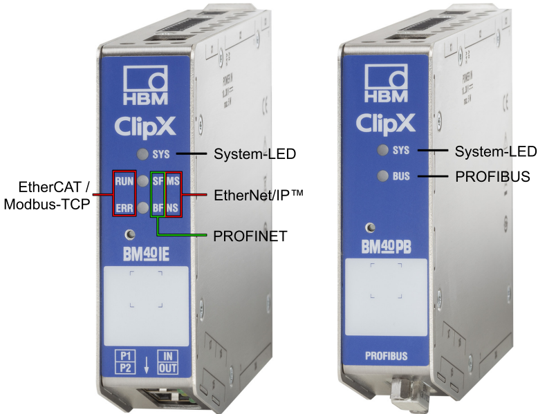
Abb. 13: Zuordnung der LEDs zu den Schnittstellen bei BM40IE und BM40PB. Bei BM40 ist nur die System-LED vorhanden.
